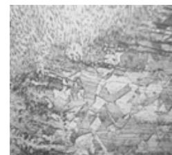
Figura 7. Micrografía de la unión de acero A304 con aporte E309L. Fuente: López (2019).
