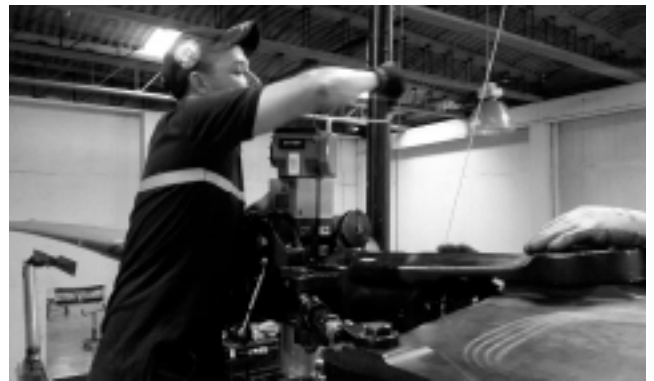
Figura 3. Procedimiento técnico, remoción tuerca del mástil.
