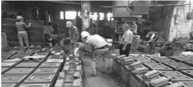
Figura 3. Colada en moldes de arena. Fuente: Servicio Industrial Ramírez.
