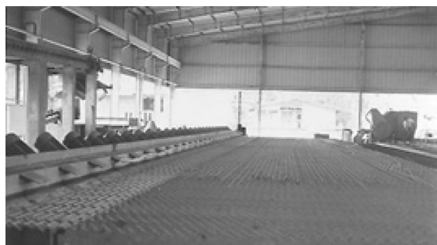
Figura 2. Cama de enfriamiento y producto terminado. Acero para hormigón. Fuente: elaboración propia, Indeta, 1993.
