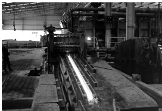
Figura 1. Proceso de laminación. Fuente: elaboración propia, Indeta, 1993.
